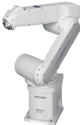
Bildunterschrift zu Abbildung 2: Neben dem abgebildeten Knickarmroboter RV6-SL bietet der Bereich Fabrikautomation auch Roboter für das Palettieren und Umsortieren, Präzisionsroboter für das Mikro-Handling, z. B. in der Uhrenfertigung, sowie die zugehörigen Steuerungssysteme
